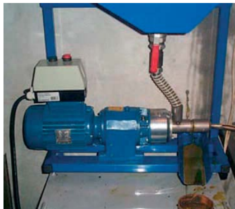
Her ses en mindre oliepresser i gang med at presse rapsfrø. Rapskagen forlader oliepresseren i form af aflange piller helt til højre i billedet .
